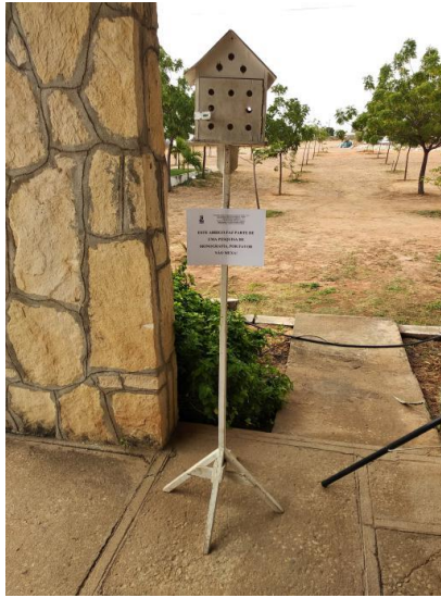
Figura 11: Abrigo meteorológico construído de madeira
